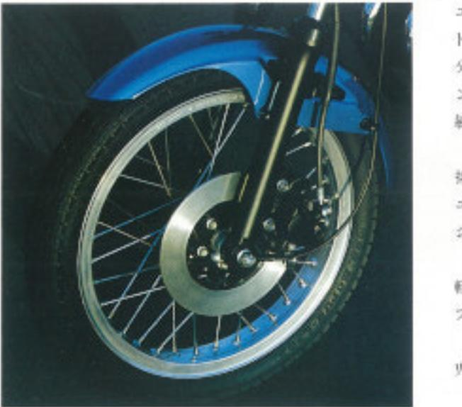
軽量アルミ中空リムを採用した前後スポークホイール。徹底軽量設計のための配慮。ノックダウン重量を軽減して、〈CB250RS〉の俊敏フットワークを支えます。
