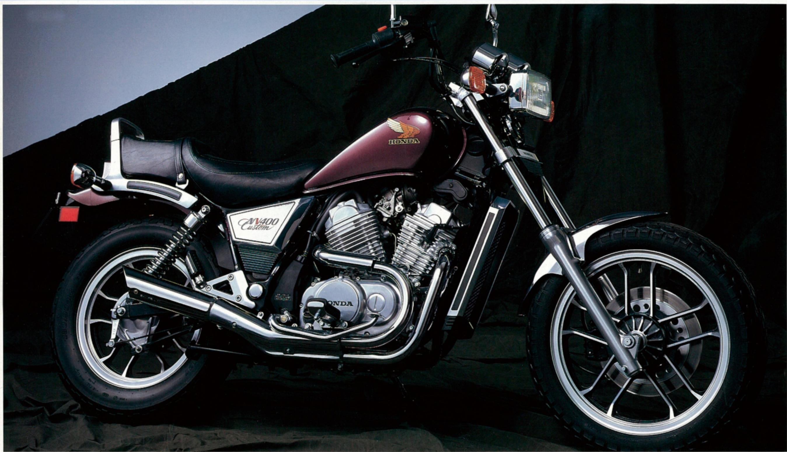
ホンダではアメリカンタイプのバイクを、カスタムと称した。新作 52 度 V ツインエンジンは、デュアルピン（位相クランク）を採用して、振動低減とテイストの両立を狙った。カスタムらしく長いフロントフォーク、スラッシュカットマフラー、プルバックハンドル、ワイドな 16 インチリヤホイール、段付きシートをセット。同時期に販売された縦置きクランクを持つ GL 系エンジン搭載の CX カスタムと同じ最高速度 155km/h を記録した
