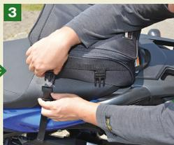
バッグのサイドにバックルがついているので、それらをX型ベルトのバックルに固定する。
