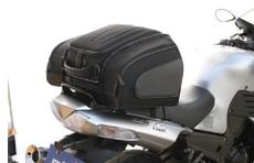
フレームや荷掛けフック、またはシートにベルトで固定して取り付ける取り付け方法だ。
